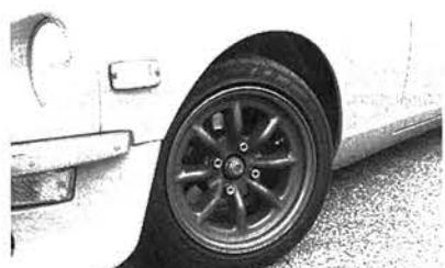
↑足は前後日産レース用オプション車高調、ダンパーはHTS。15インチのワタナベにタイヤはネオバ。
