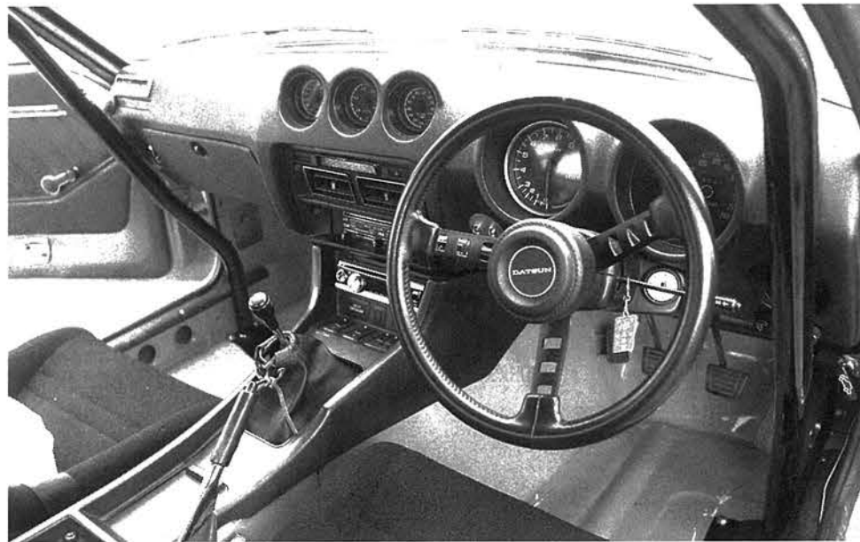
↑ワークステラモトでS30のボディをレストア&補強&塗装してこんなにきれいになった。ステアリングはダツコンベ、正面にデフィのタコメーターを装着。M/TはOSの71C用5速フルクロスに変更した。
