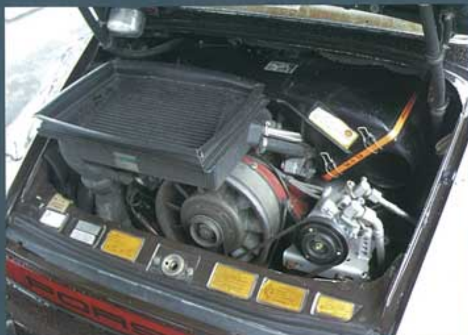
↑上部の四角い箱がボルシェターボのノーマルインタークーラー。3.3エンジンにはまだバラしていない。やはり電機系が弱点。
