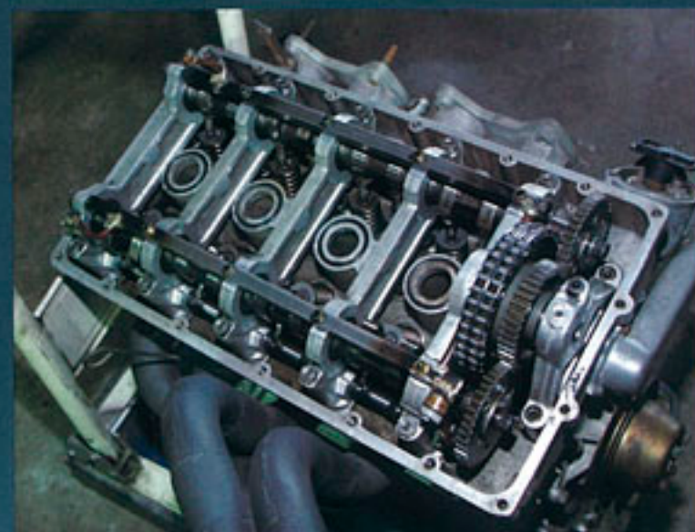
↑これが長瀬発動機に残されていたTC16。L6用のTC24のように直接カムシャフトをチューン駆動せず、ギアを介して左右のカムを回す。バルブの作動はロッカーアーム方式。
