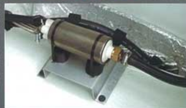
↑トランク内に設置された燃料ポンプはボッシュ。レギュレーターは亀有を使ってウェーバーの油面を確保する。
