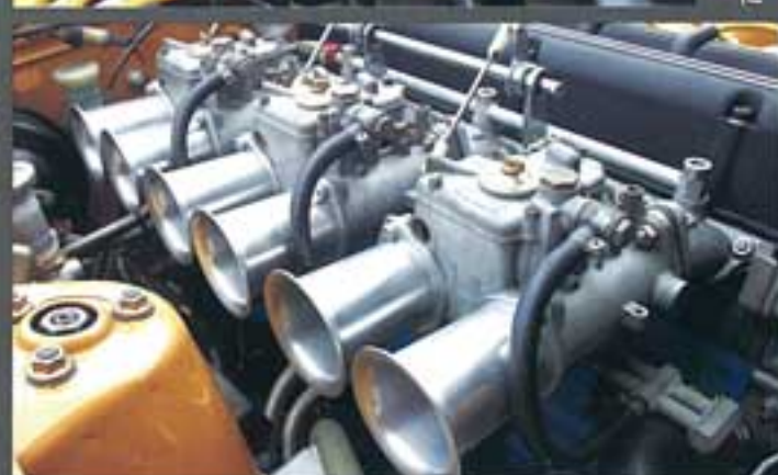
↑キャブは50φウェーバー、下側の燃料配管は燃圧を安定させるために後端を延長してリターン。燃料ポンプはBMW用ポッシュ。
