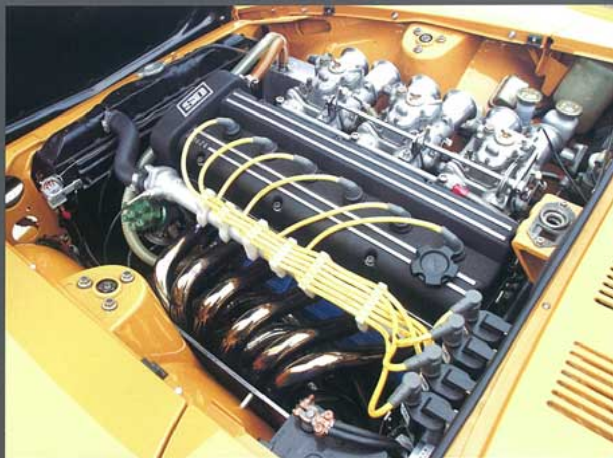
↑↓搭載されたTC24を載せたL28改。ピストンはLZ16改87.8φ、コンロッドはL20のピン径を23.5φに変更してタフト加工、L28クランクはTC24用ダンパーブリーがスプライン嵌合なので先端を加工してフルバランス取り。
