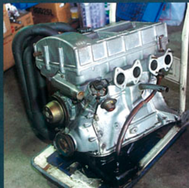
↑これが長瀬発動機に残されていたTC16。L6用のTC24のように直接カムシャフトをチューン駆動せず、ギアを介して左右のカムを回す。バルブの作動はロッカーアーム方式。
