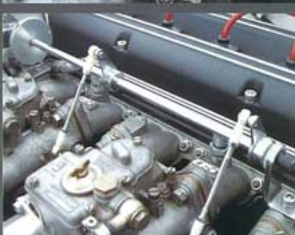
←48φウェーバーのリンケージも可動部は新しく製作している。
