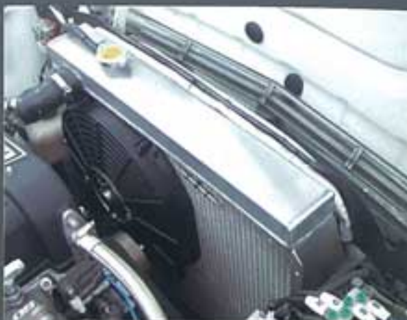
←ラジエターはアルミ3層に変更、エンジンファンを外したので電動ファンを装着。
