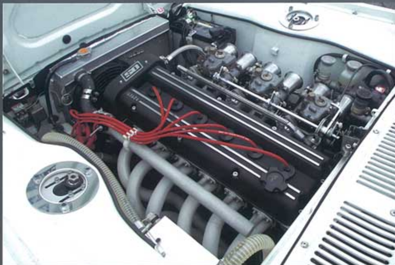
↑TC24に組まれたカムは275度/275度9.75mmリフト。バルブS/Pはシングル、リテーナーはチタン。ピストンはOSの89φ鍛造に変更、オイルパンはスカイライン用に後ろ側の油溜まりにして油量増し加工を施す。
