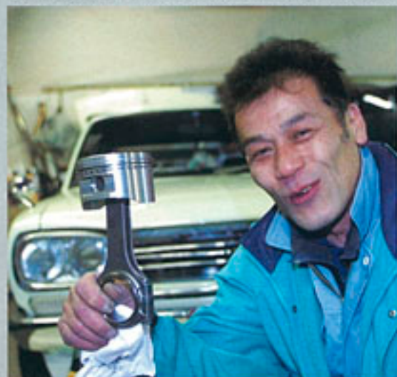
↑OS89φ鍛造ピストンとH断面コンロッド。これが片岡ハコスカのエンジンに組み込まれている。
