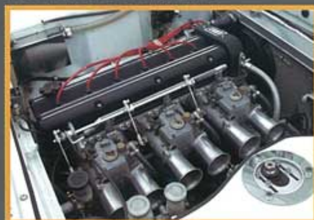
↑ハコスカに搭載されたOSのTC24ツインカムヘッド。同じクロスフローでもS20とはまた別の雰囲気がある。
