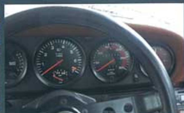
↑930ターボの純正メーター。レブは6800回転、速度計は300キロフルスケール。完調なら280近く出る。
