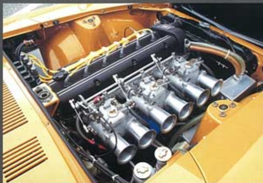
↑↓搭載されたTC24を載せたL28改。ピストンはLZ16改87.8φ、コンロッドはL20のピン径を23.5φに変更してタフト加工、L28クランクはTC24用ダンパーブリーがスプライン嵌合なので先端を加工してフルバランス取り。
