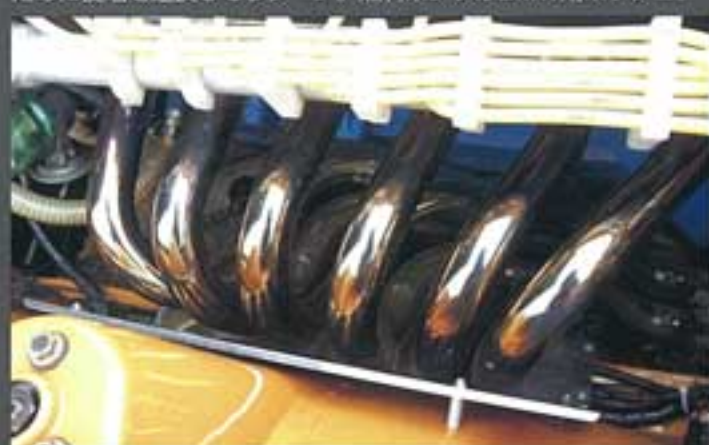
↑タコ足は42φOSノーマル。ステンではなく、鉄製のパイプをメッキした曲げ物。TC24用はモナカ鋳造を溶接した製品。
