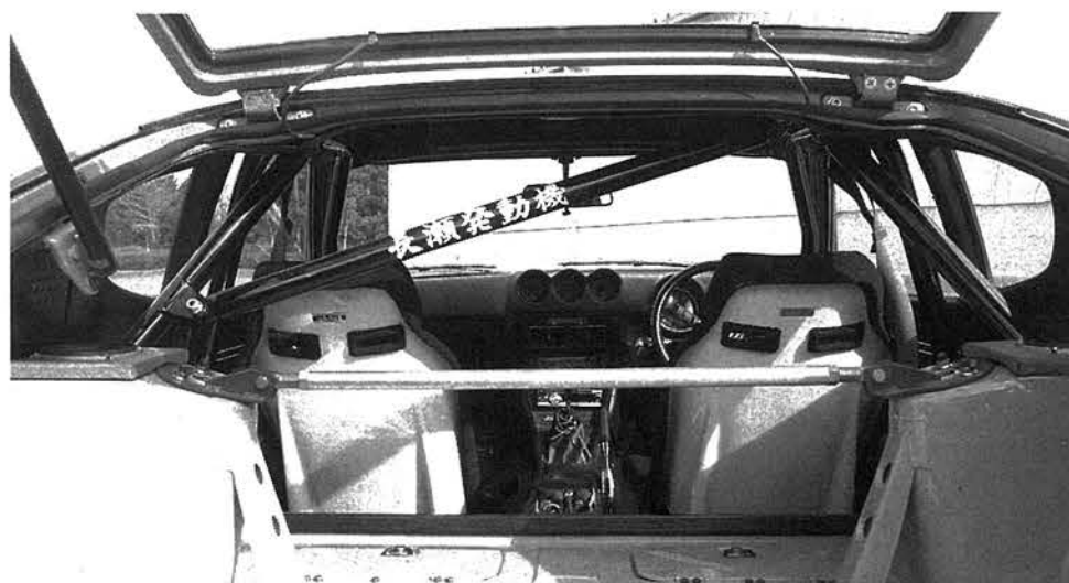
↑サビだらけのS30をワークステラモトでレストア&補強。車載にあたっては長瀬発動機の手を借り、多くの友人たちの協力でTC24が動き出すことになった。シートはオートルックのフルバケ、ベルトはダイハツのミラコール純正流用。
