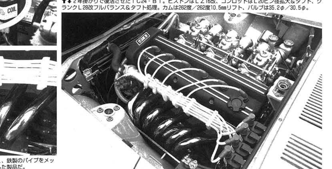
↑タコ足は42φOSノーマル。ステンではなく、鉄製のパイプをメッキした曲げ物。TC24用はモナカ鑄造を溶接した製品だ。
