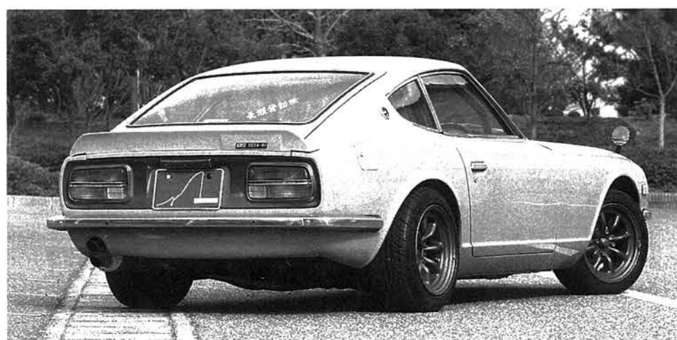
↑サビだらけのS30をワークステラモトでレストア&補強。車載にあたっては長瀬発動機の手を借り、多くの友人たちの協力でTC24が動き出すことになった。シートはオートルックのフルバケ、ベルトはダイハツのミラコール純正流用。
