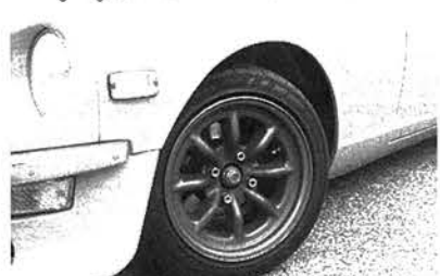
↑足は前後日産レース用オプション車高調、ダンパーはHTS。15インチのワタナベにタイヤはネオバ。
